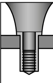
2. Nýtovací matici usadte do montážního otvoru
