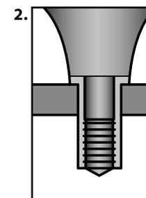
2. Nitovaciu maticu usadíte do montážneho otvoru
