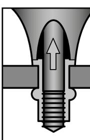
3. Stiskněte rukojeti kleští k sobě. Míra stisku určuje délku spoje, kterou lze odečíst na měřídle. Tím dojde k usazení matice a spojení dvou dílů.
