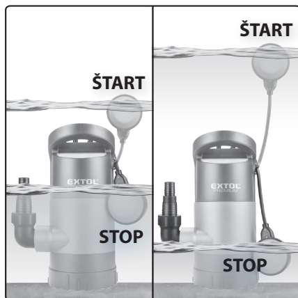
Obr. 4, ilustrácia funkcie plavákového spínača
